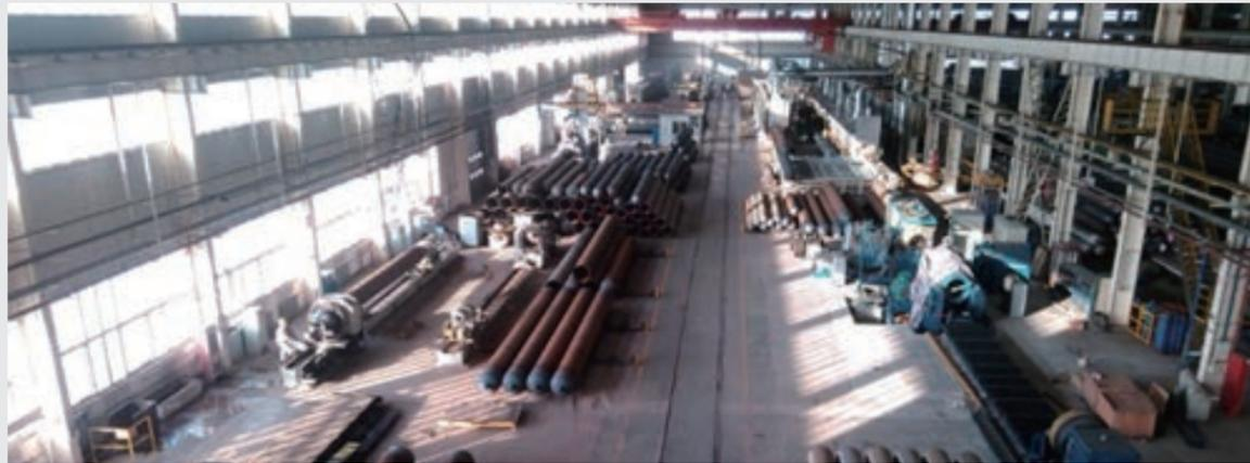
1、科学布局：充分利用有效空间，合理布局旋压机、热处理炉、研磨机等大型设备，实现了原有生产线的流线化改造和产能提升。
