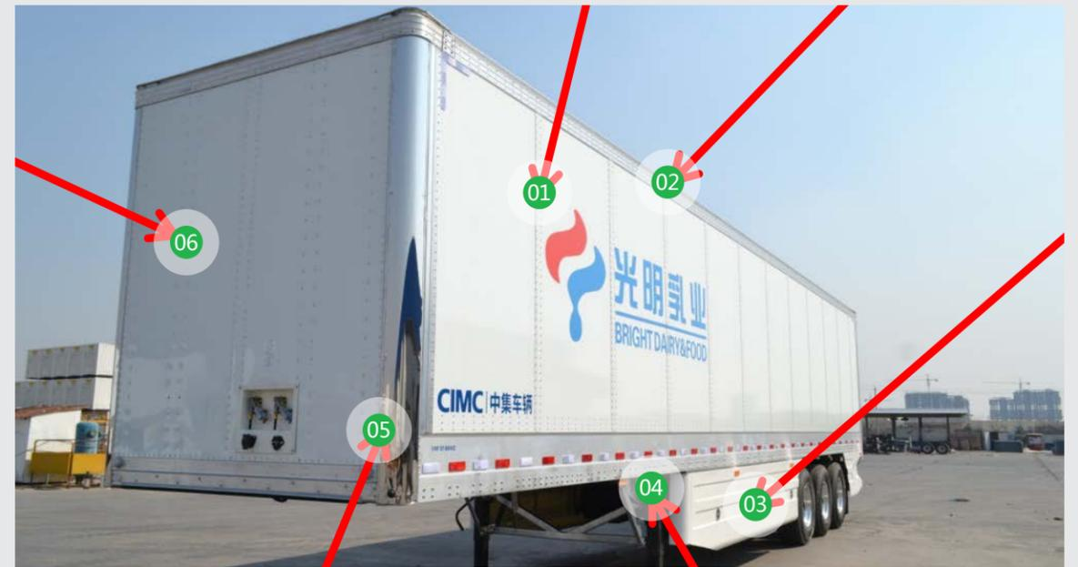
01-复合板连接技术 02-铝合金顶侧梁技术 03-空气动力学节能技术 04-箱体承载技术 05-密封技术 06-材料加工技术
